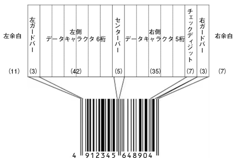
図 2 113 モジュールの構成
